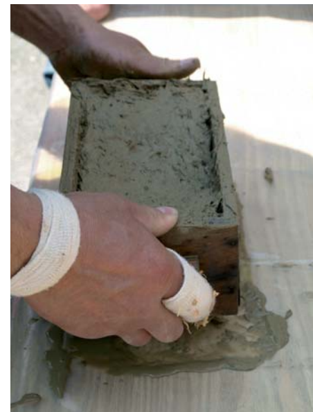
Priprema za vađenje ćerpiča iz kalupa
